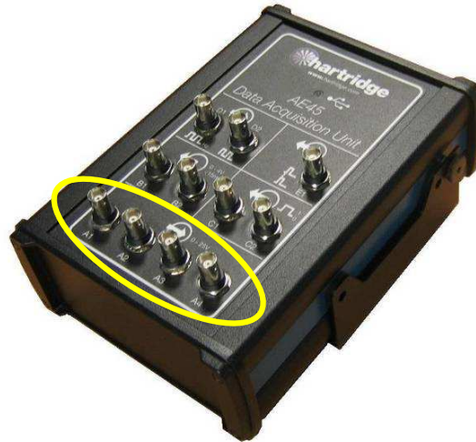
Figura 2.4: Entradas analógicas AE45 (A1 a A4)
