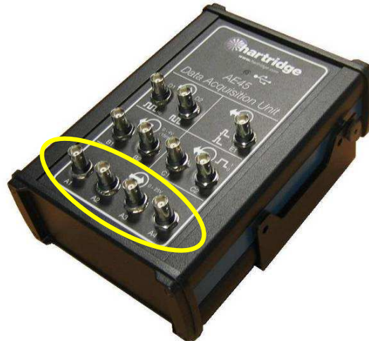
Figura 2.4: Entradas analógicas da AE45 (A1 a A4)
