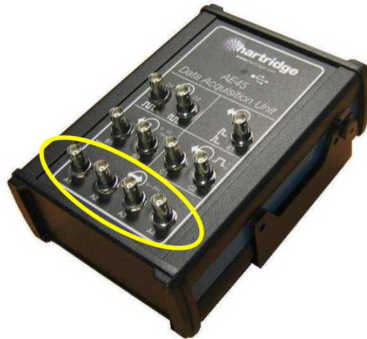
Afbeelding 2.4: AE45 Analoge ingangen (A1 tot A4)
