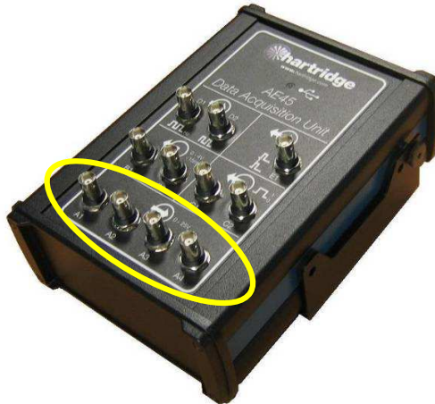
Figure 2.4 : Entrées analogiques de l'AE45 (A1 à A4)
