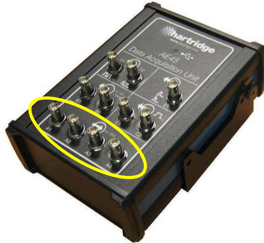
Abb. 2.4: Analoge AE45 Eingänge (A1 bis A4)
